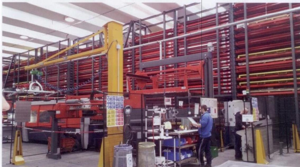
Il reparto produttivo all'interno di Sematic: è ben visibile il magazzino lamiere che asserva le tre macchine laser
